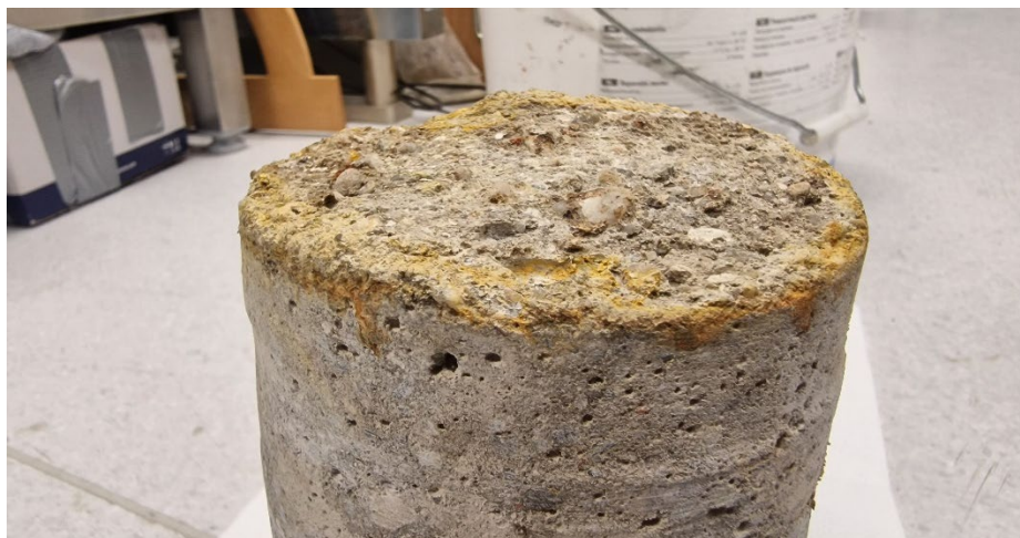
Fot. 48. Próbką rdzeniowa S3. Korozja na powierzchni betonu
