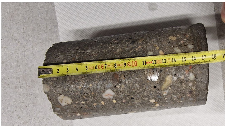
Fot. 43. Widok próbki rdzeniowej nr S1. Pomiar grubość otuliny - 5 cm
