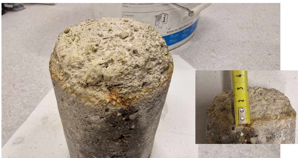
Fot. 51. Próbką rdzeniowa S4. Korozja na powierzchni betonu
