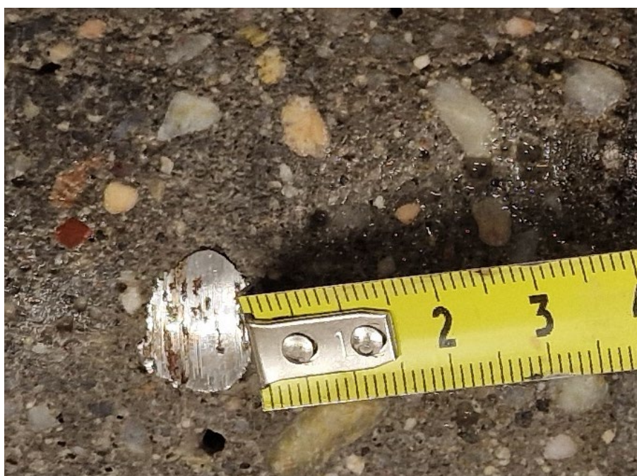
Fot. 52. Stan pręta zbrojeniowego w próbce S1
